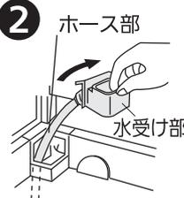
ホース部 給水パイプを引き抜き、流水で水洗いする。
