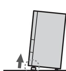
※設置から数日後、重みで床が沈むことがあります。調整脚で傾きを再調整してください。
