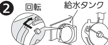
給水ポンプは給水タンクへ確実に回転して取り付ける。
