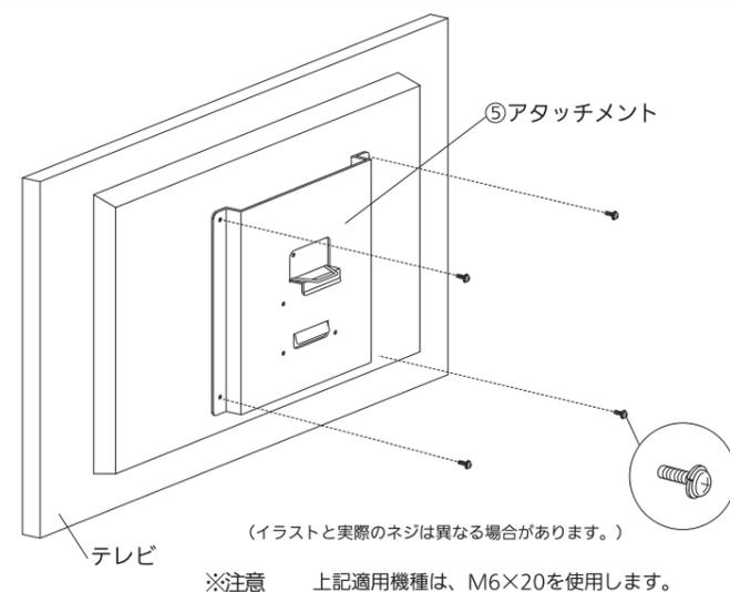
アタッチメントをテレビ背面に取付します。フラットTV設置用ビスパックより、テレビ本体に設けられたネジ寸法に適合した物を選定の上、取付してください。
