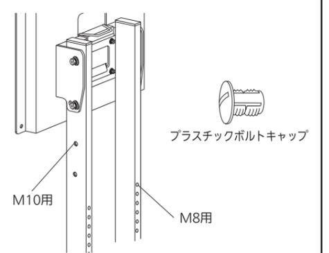
組立時に使用しなかったブラケット金具取付穴と、棚板取付穴を付属のプラスチックボルトキャップで塞いでください。
