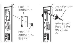
※ネジを締める際、斜めに締めたりしないようにご注意ください。 ネジ山がつぶれて取付けできなくなります。
