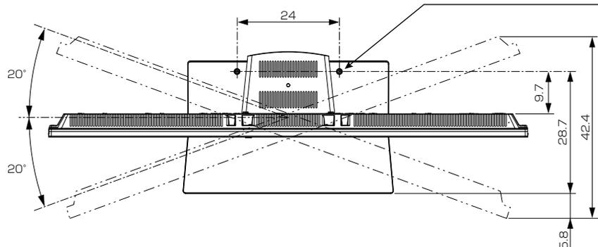
転倒防止固定ネジ穴部 断面図
