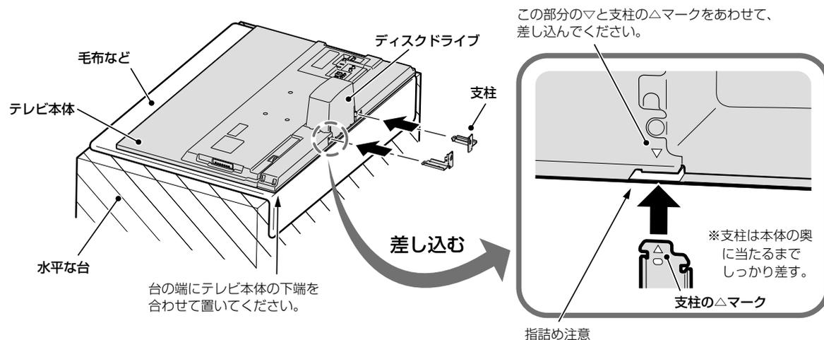
2. 付属のスタンド取付ネジ(M4×10)で、本体と支柱をしっかりとネジ止めする
