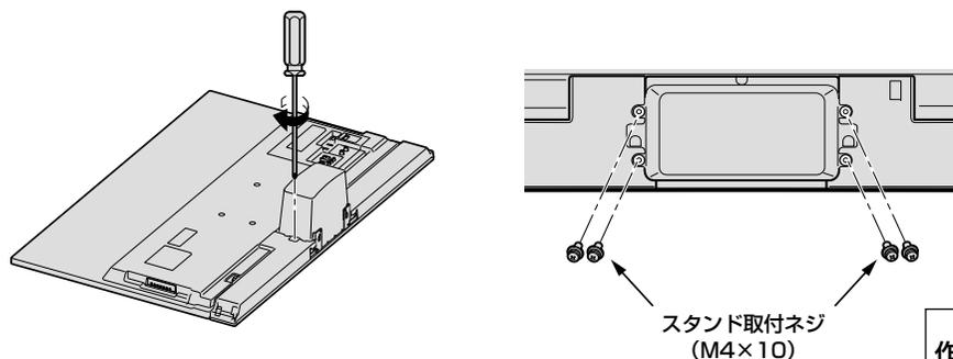
3. 図のように壁掛け金具取付用金具(MK06BDアダプタ)、カバーを取り付ける
