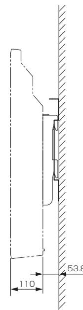
※1：液晶テレビへの取り付けには、付属の液晶テレビ取り付け用ネジ(M6×20)とM6平ワッシャー(t=1.6)を使用してください。
