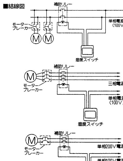
■接続図 大容量換気送風機及び換気送風機を2台以上並列運転させる場合
