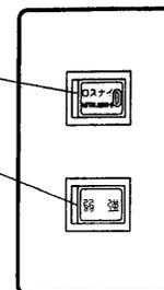
電源スイッチを「入」にし、風量切換スイッチを「強・弱」に切り換えたときロスナイの給・排気の風が強・弱に切り換わるか確認する。
