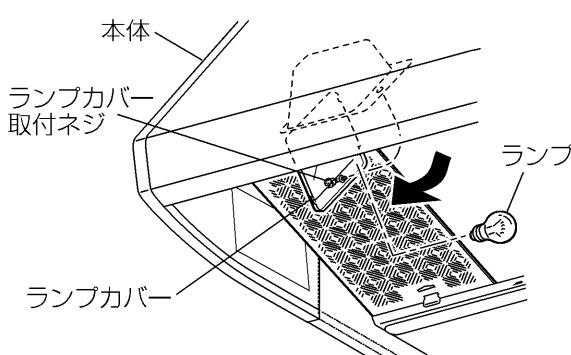
1 ランプカバー取付ネジをゆるめ、ランプカバーを開ける。
