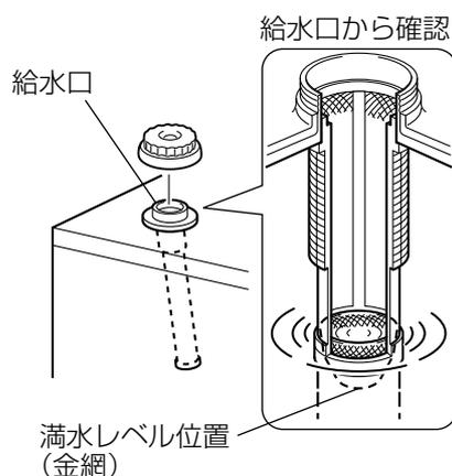
1 か月間に数回、循環液不足となる場合は水漏れの可能性がありますので、本体や温水配管接続部から防錆循環液が漏れてないか確認してください。
