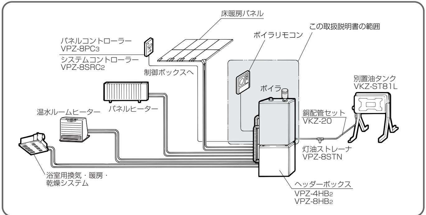
油だき温水ボイラはエアリゾート(換気・冷暖房システム)で温風を作るために必要なものです。
