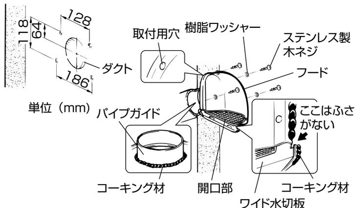
1. 左図を参照してあらかじめ外壁にφ4.8、深さ45mmの穴を4か所あけ、市販のカールプラグ(#8)を挿入する。
