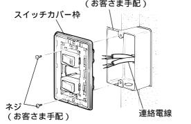
連絡電線の接続とスイッチカバー枠の固定 あらかじめ用意されている連絡電線を結線図に従って 端子台へ接続し、1個用スイッチボックスに取付ける。 連絡電線【単線 1.6 例 ) VVF】
