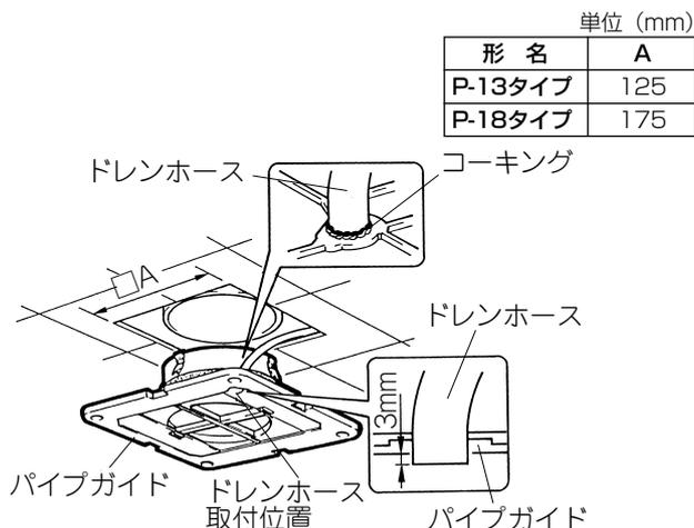
1. 天井材の取付位置にAmm角となるよう角穴を開ける。
