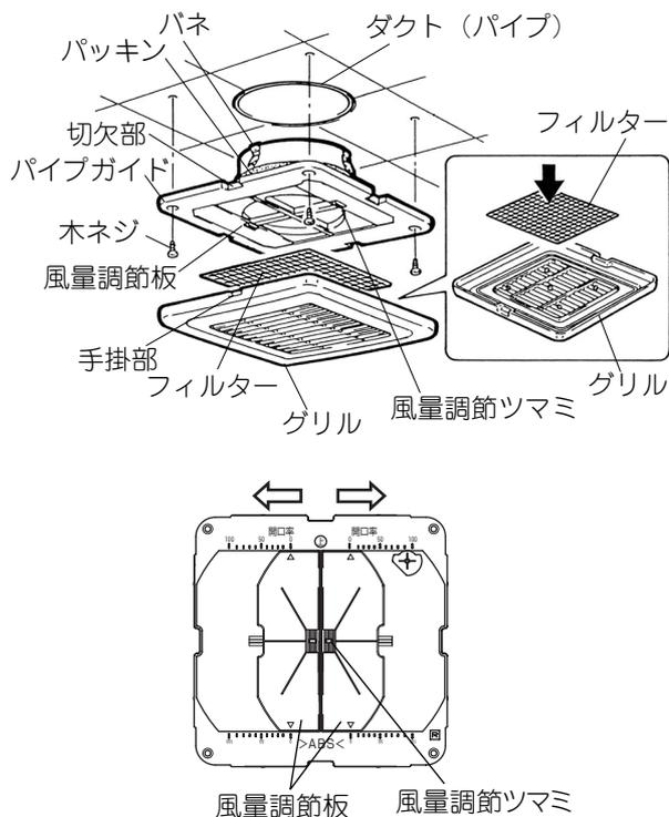
1. パイプガイドをダクトに差し込み、付属の木ネジ (4本) で天井材に締め付ける。
