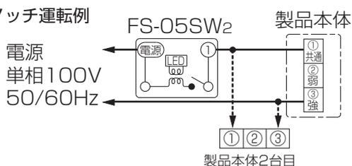
電線は単線φ1.6またはφ2.0を使用。先端12mm皮むき後、確実に差し込む。
