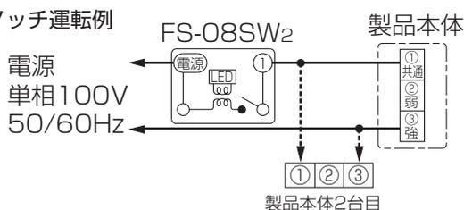
電線は単線φ1.6またはφ2.0を使用。先端12mm皮むき後、確実に差し込む。
