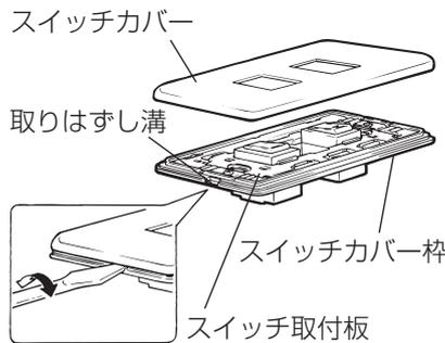
**2** 連絡電線の接続とスイッチカバー枠の固定
