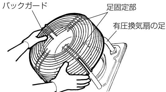
有圧換気扇にバックガードをかぶせる。
