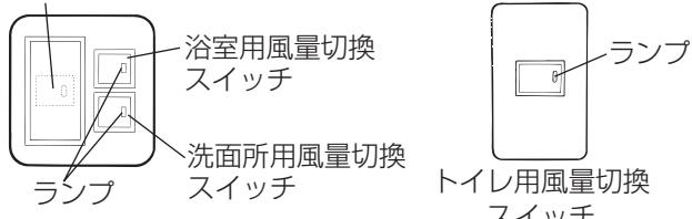
■急速に換気したいとき風量切換スイッチを右側に押すと、ランプが点灯し「強」運転に切換わります。
