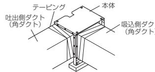
角形フランジと角ダクトを接続してリベットで固定し、風漏れや水浸入がないようシール材を塗布した上で、市販の屋外用シールテープでテーピングする。
