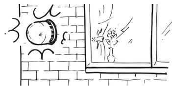
取付けないと風雨の浸入により故障の原因になります。
