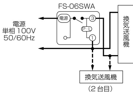
あらかじめ用意されている連絡電線を結線図に従ってコントロールスイッチの端子台に接続し、1 個用スイッチボックスに取付ける。
