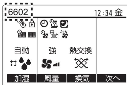
非常用電源を受電時、直膨コイルの温調は「サーモ OFF 固定」となるため、加湿運転時は加湿量が減少し、除湿運転時は除湿量が減少します。また、吹出温度制御（冷風防止制御、温風防止制御）も無効となります。
