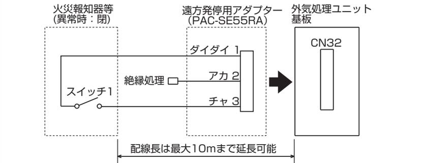
※強制停止させたあと、スイッチ 1 が開放になったとき、外気処理ユニットは [停止] を継続します。
