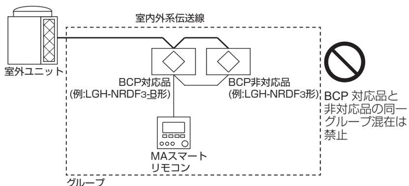
高顕熱形室外ユニットをご使用の場合、同一冷媒系統内に LGH-NRDF3 (-B) 形 (ドレンアップメカ内蔵形含む) 以外の外気処理ユニットは接続できません。
