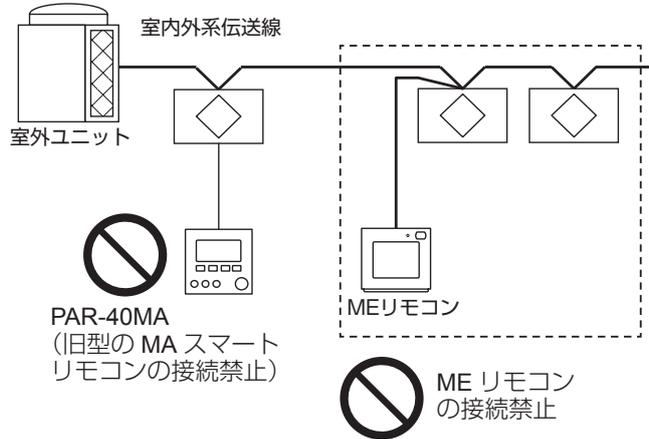
本製品はリモコン無しのシステム (例: システムコントローラのためのシステム) では使用できません。
