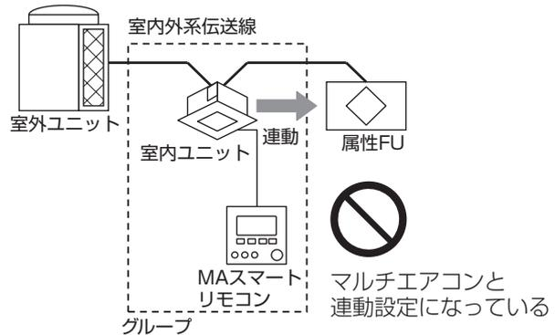
非常用電源は BCP 対応する外気処理ユニットのみ接続し、室外ユニットや分流コントローラは接続しないでください。
