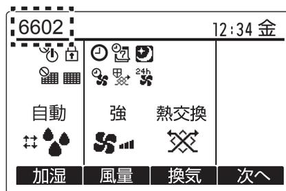
全てのユニットが通常用電源にて運転時に MA スマートリモコンに異常コード（点検コード）「6602」、「6603」または「6607」が表示された場合、外気処理ユニットを含むシステムの通信異常または回路基板故障が考えられます。お買い上げの販売店にご相談ください。
