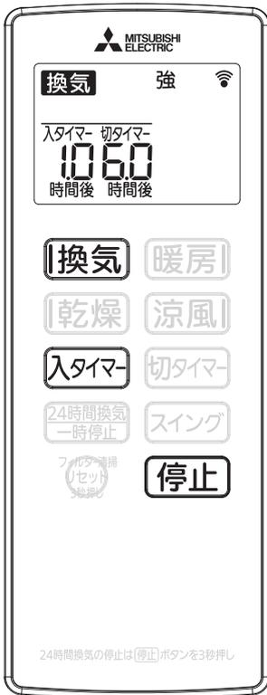
**入タイマー** を押して運転開始までの残りの時間を調整する
