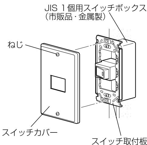
スイッチカバーの保護シートをはがし、スイッチカバーをスイッチ取付板に取付ける。
