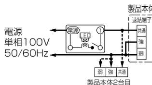
電線は単線の1.6またはφ2.0を使用。先端12mm皮むき後、確実に差し込む。
