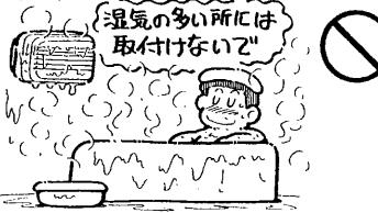
製品の変形・モーター焼損の原因になります。
