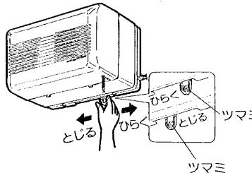
運転停止後、外風の侵入を防止するため本体下部後側にシャッターが取付けてあります。運転するときはシャッターのツマミを右側「ひらく」へ動かします。
