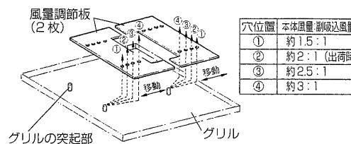
●本体グリルの風量調節板は、工場出荷時、本体風量：副吸込風量を②約2:1にセットされていますが風量調節板を移動することによって①約1.5:1、③約2.5:1、④約3:1まで変えることができます。
