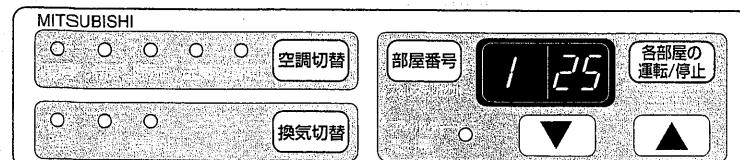
エアリゾート本体についているセンターコントローラで、空調モード(暖房・冷房・除湿・送風)と換気モード(強・弱)を決めます。
