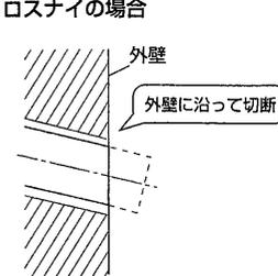
給排気パイプを左図のように取付けます。
