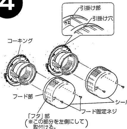
1.フード取付板と壁面のすき間を市販のコーキング剤で埋めて雨水の浸入を防止する。
