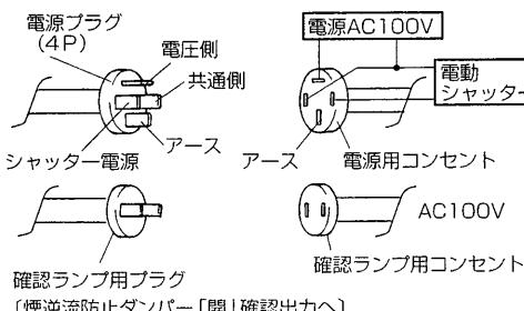
電源プラグと同形のコンセントを設けて電源プラグを差し込む。
