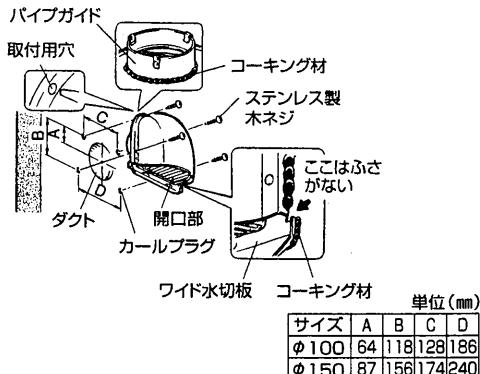
1. 左記の寸法表を参照してあらかじめ外壁にφ4.8、深さ45mmの穴を4か所あけ、市販のカールプラグ(#8)を挿入する。
