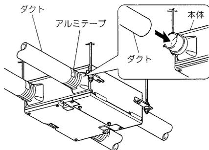
**注意** ●ダクトは雨水の浸入を防ぐため、屋外に向けて1/30以上の傾斜をつける。
