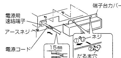
■結線図……太線部分を結線してください。コードは約2mの余裕をもって配線する。
