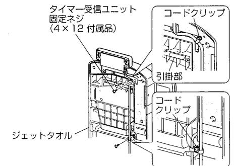
※ジェットタオル側のコードクリップと信号線用のコードクリップは共締めします。
