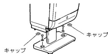
**ジェットタオルの取りはずし** ※説明の図はJT-SB116EHを示すコンセントを使っている場合と専用配線を使っている場合があります。
