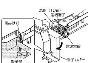
■結線図(太線部分を結線する)
