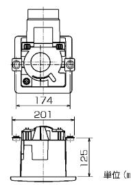
システム部材の天吊金具(P-02TK)のツメを本体に引っかけて、内側から取付ネジで固定する。
