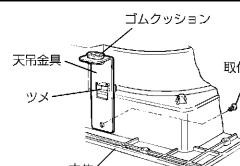
本体が水平になるように天吊金具を吊りボルトに取付け、ナットがゆるまないようワッシャー・ナットで確実に固定する。
