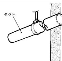
壁排気穴から本体のダクト接続口までダクト配管する。
