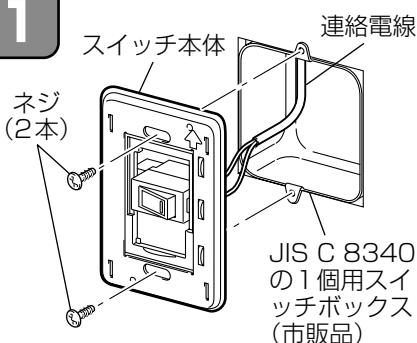
あらかじめ用意されている連絡電線を、上の結線図に従って壁埋込スイッチ本体に接続する。
