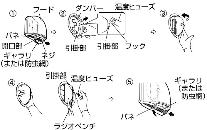
①ギャラリ(または防虫網)を止めているネジ1本をゆるめ、ギャラリ(または防虫網)を下に引き、バネからはずす。
