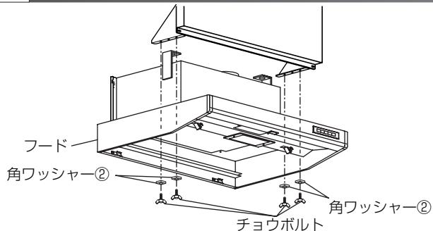
1 フードに付属のチョウボルト（4個）、角ワッシャー②（4個）で上幕板固定金具を固定する。
