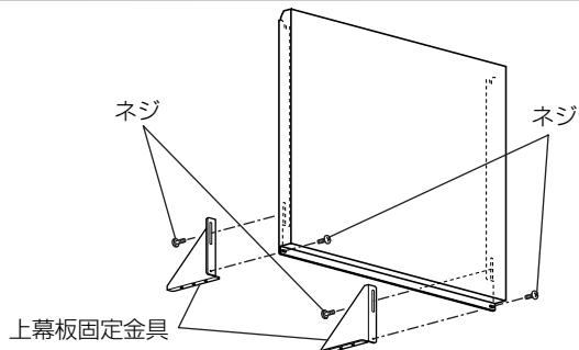
1 上幕板に付属のネジ（4本）で上幕板固定金具を取付ける。
