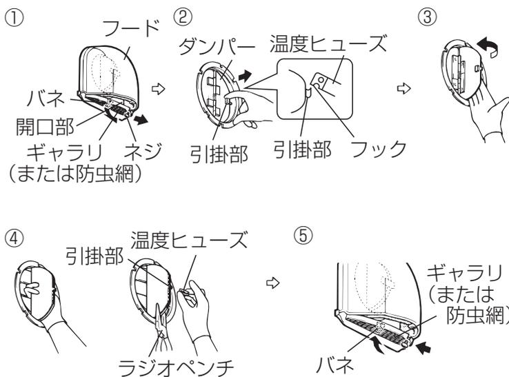
①ギャラリ(または防虫網)を止めているネジ1本をゆるめ、ギャラリ(または防虫網)を下に引き、バネからはずす。
