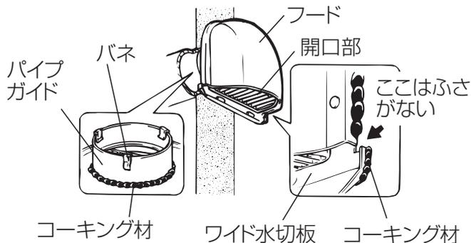
1. フードを取付ける前に、市販のコーキング材で図のようにパイプガイドに防水処理を施す。
