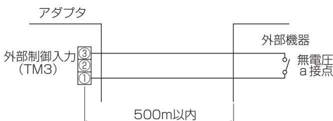
パルス信号出力を外部制御入力(TM3)の①③に接続する。
