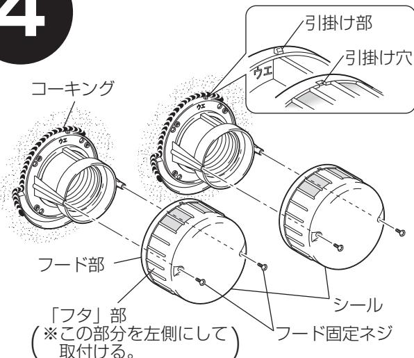
1. フード取付板と壁面のすき間を市販のコーキング材で埋めて雨水の浸入を防止する。
