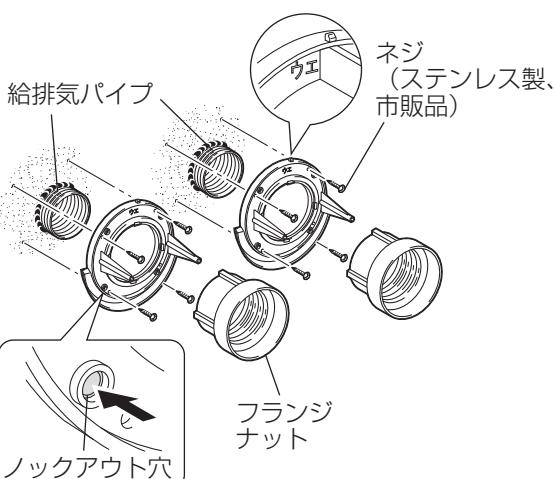
3. フード取付板を壁に市販のネジ（ $\phi 4 \times 20$ ステンレス製）4本で固定する。
