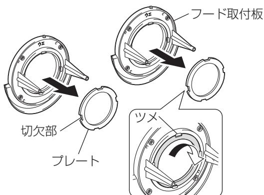
2. フード取付板のツメ部に付属のプレートの切欠部をはめ込み回して確実に取付ける。
