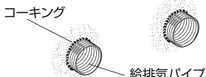
給排気パイプと壁穴のすき間を市販のコーティング材で埋める。
