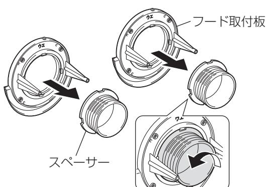
1. 左図の矢印方向へスペーサーを回してフード取付板から取りはずす。
