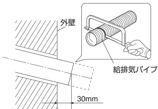
給排気パイプを左図のように取付けます。
