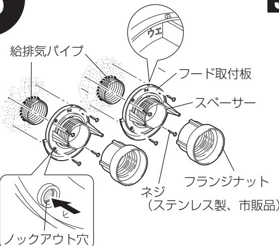
1. フード取付板を壁に市販のネジ（ $\phi 4 \times 20$ ステンレス製）4本で固定する。
