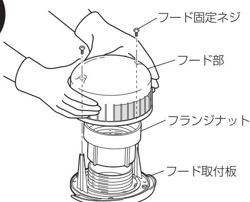
フード(2個)のフード固定ネジ(各2本)をはずし、フード取付板、フランジナットを取りはずす。
