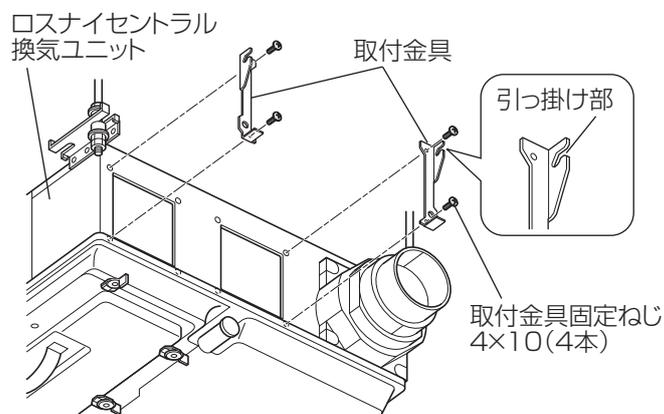
3. 端子台カバーが右図(RA1側)になるよう取付金具の引っ掛け部2か所に風路切替ダンパーの突起部を引っ掛け、付属の風路切替ダンパー固定ねじ4×10(4本)で取付ける。
