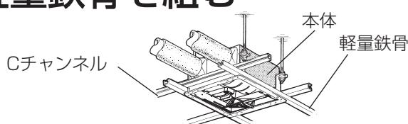
**軽量鉄骨と開口部補強用のCチャンネルで左図のように組む**
