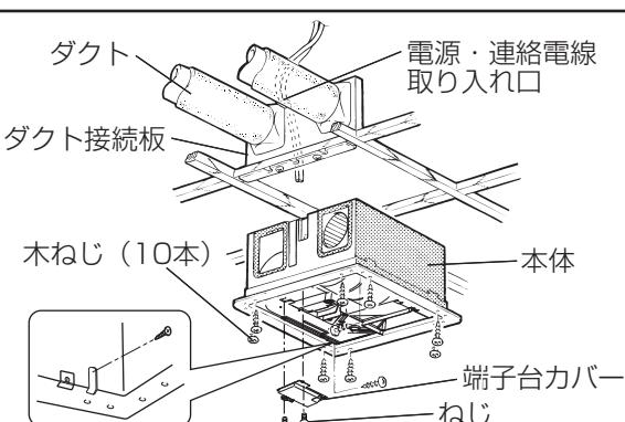
天井の野縁と補助野縁で取付枠を組む
