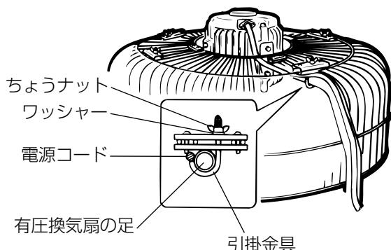
引掛け金具を有圧換気扇の足に引掛けちょうナットで確実に締付けます。
