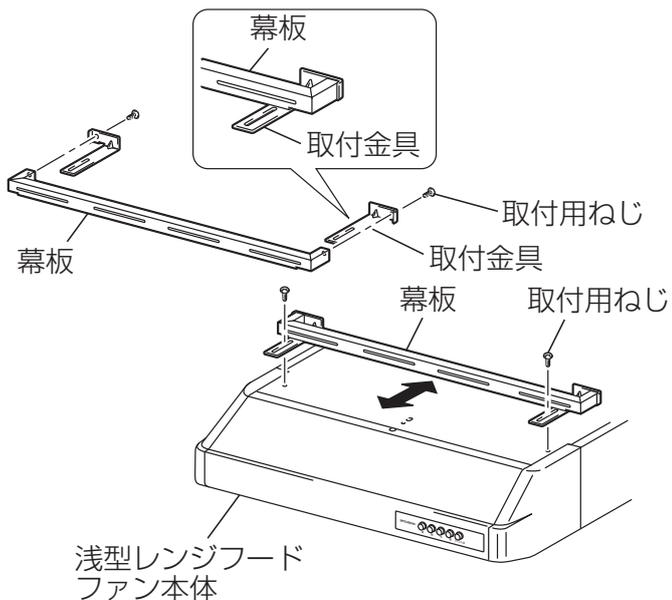
1. 付属の取付金具に取付けてある取付用ねじ 4 本をはずします。
