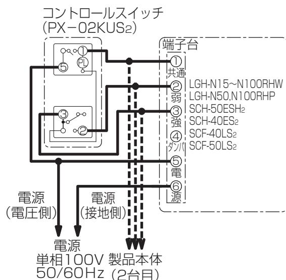
※漏電保護用に電源側へ漏電ブレーカーをご使用ください。
