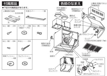
本体の据付けには、天井据付けと壁据付けがあります。 この製品は給・排気方向を後・上に選択できます。 詳しくは裏面を参照ください。
