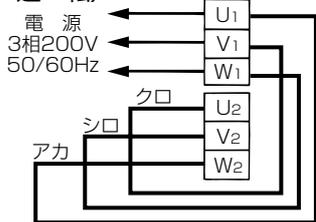
※U<sub>1</sub>, V<sub>1</sub>, W<sub>1</sub>に電源線を接続してください。
