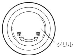
グリルの刻印「開」または「閉」方向に回して、风量を調節する。
