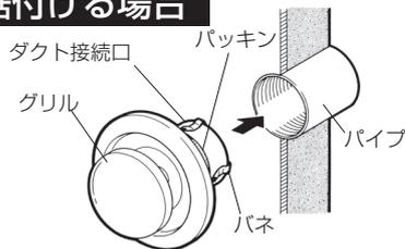
1. パイプを配管し確実に固定する。
