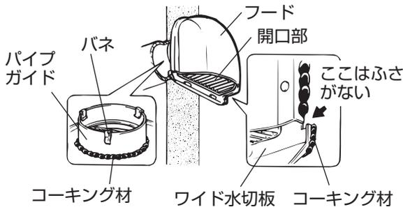
1. フードを取付ける前に、市販のコーキング材で図のようにパイプガイドに防水処置を施す。
