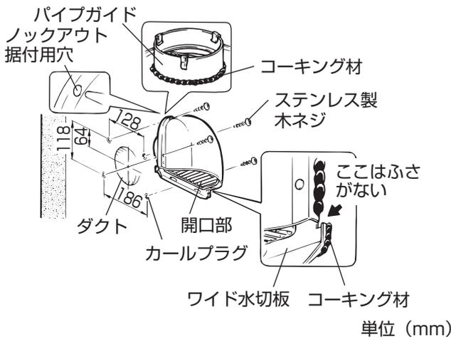
1. 左図を参照してあらかじめ外壁にφ4.8、深さ45mmの穴を4か所あけ、市販のカールプラグ(#8)を挿入する。
