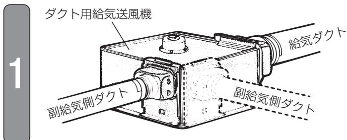
建物および部屋の配置により、副給気口方向を決める。(2方向選択式)
