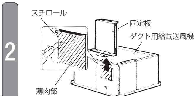
1. 使用する本体副給気口の固定板を本体上側へ引き抜く。
