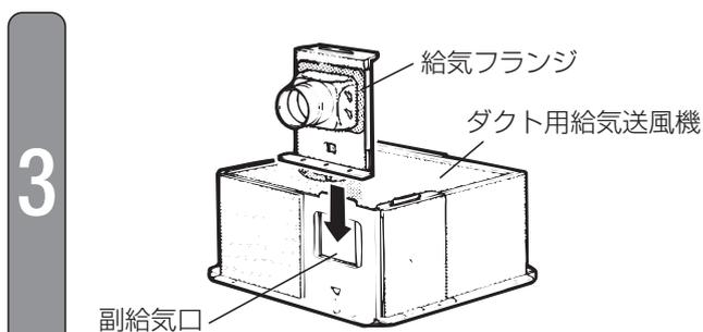
給気フランジを本体副給気口に据付ける。
