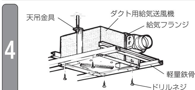
天吊金具でダクト用給気送風機を吊り、軽量鉄骨に固定する。
