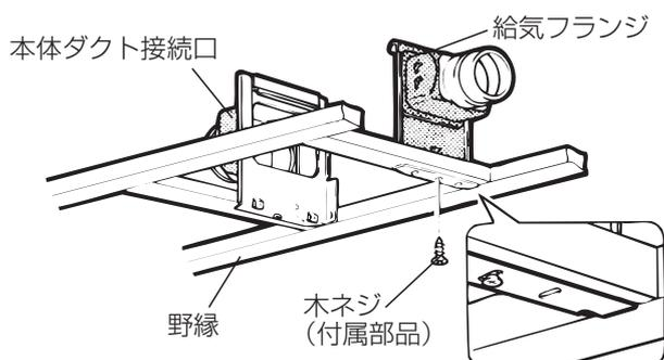
給気フランジを野縁に据付ける。
